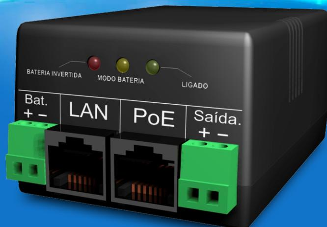
Fonte de alimentação com conexão para bateria e comutação automática em caso de falha na rede elétrica. Além de alimentar os equipamentos, fornece corrente de carga automática para a bateria. Suas principais aplicações são em sistemas que necessitam de alimentação ininterrupta, por exemplo, sistemas de telecomunicações, CFTV e alarmes
